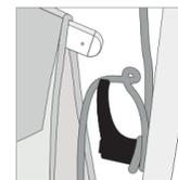
Sbloccare la cima dal sistema di bloccaggio Easy-Block e rilasciarla lentamente per rallentare la chiusura del ciuffo dell'ombrellone. Con l'altra mano si consiglia di trattenere ed accompagnare il movimento della manopola di regolazione verso il basso in modo da regolare la velocità di rientro del braccio dell'ombrellone verso il palo
