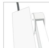
Solleverare quindi il ciuffo dell'ombrellone e inserire lo snodo presente all'estremità superiore direttamente nel braccio di sostegno, fissandolo allo stesso tramite le viti M6x20 in dotazione
